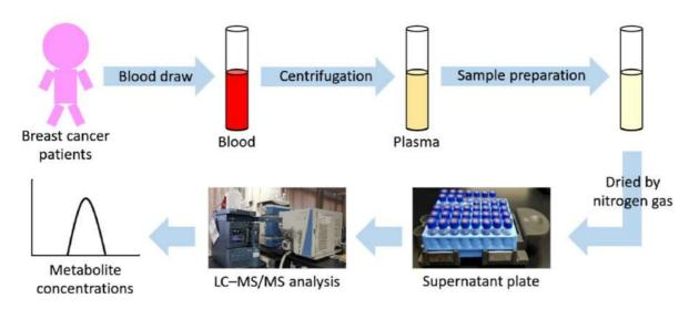
將受試者提供之血液經由離心得到血漿,稀釋血漿,吸取血漿上清液,加入代謝物內標和化學藥劑, 氮氣吹乾後回溶,LC-MS/MS上機,檢測代謝物濃度。
